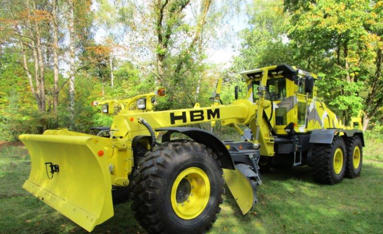
Równiarka HBM BG 240 TA-4 z opancerzoną kabiną
