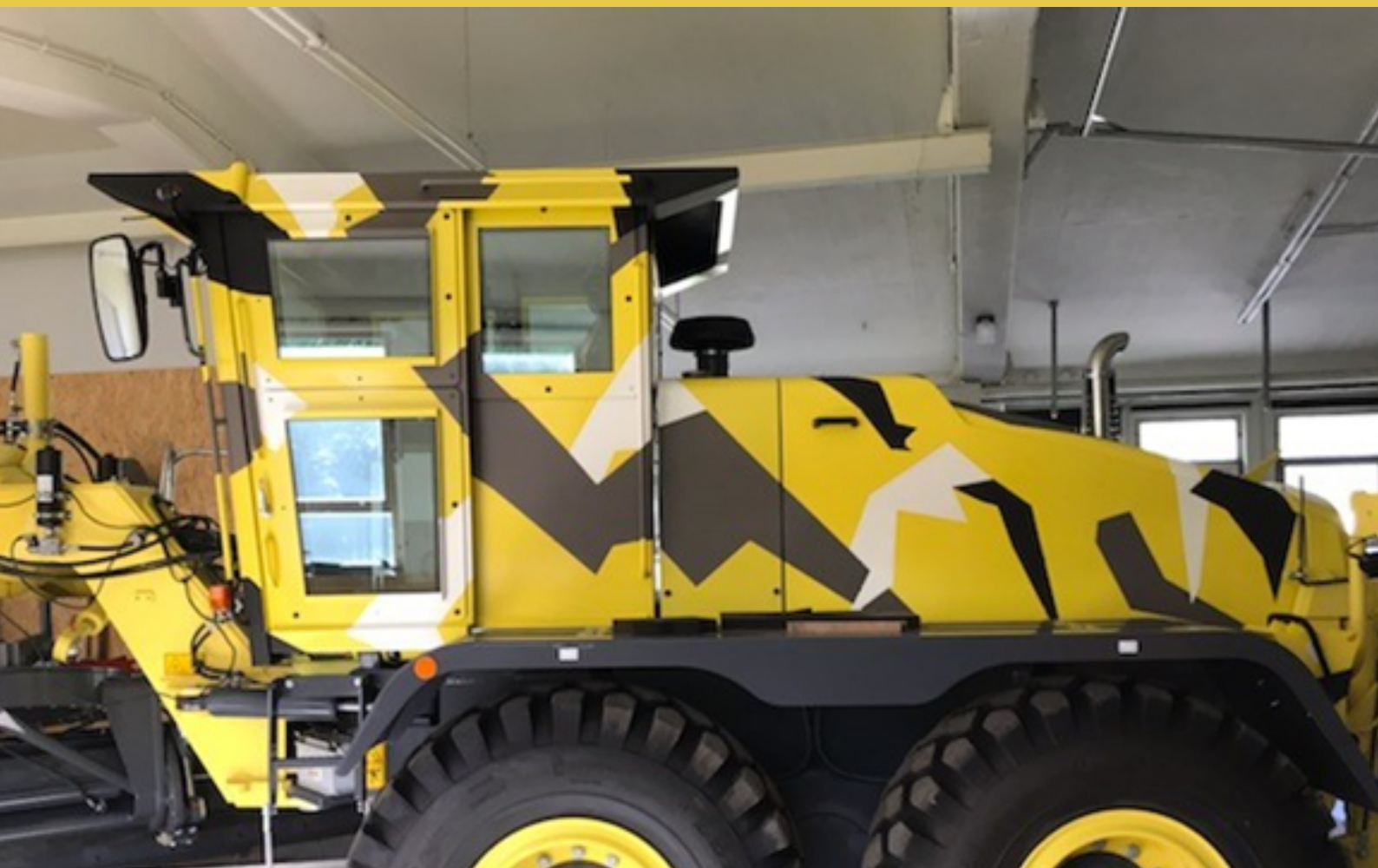
Równiarka HBM BG 240 TA-4 z opancerzoną kabiną
